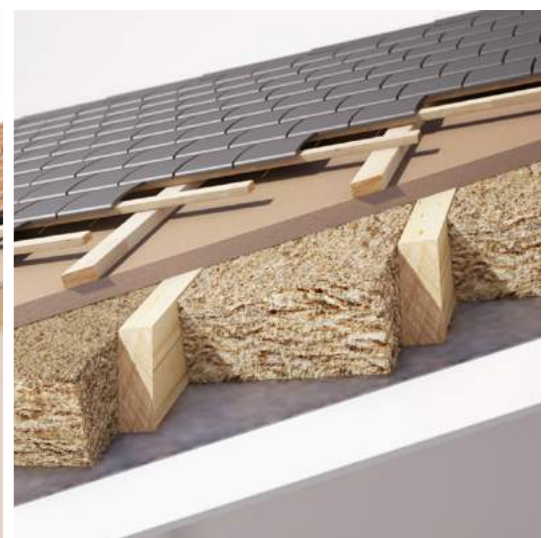
Dach nach der Renovierung (mit Dämmung)
