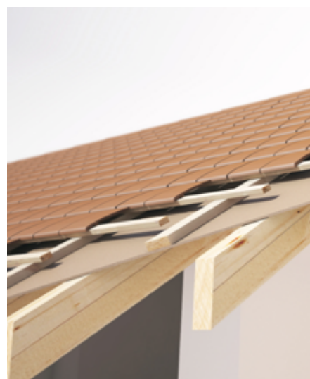
Toiture avant rénovation (sans isolation)
