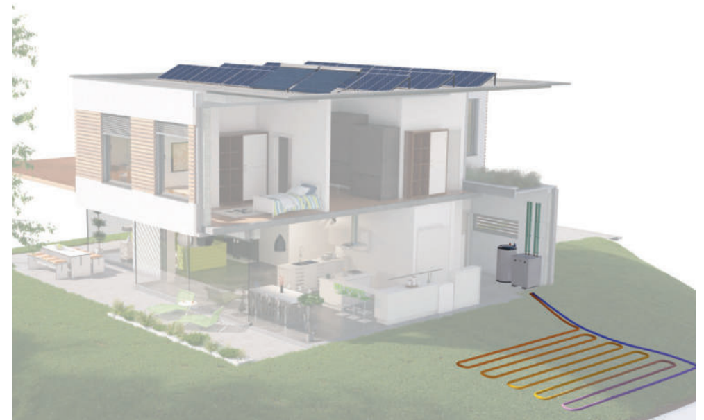
Thermische Solaranlage – Flachkollektor, Erdwärmepumpe
